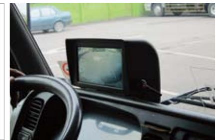
▲顯示器安裝位置
