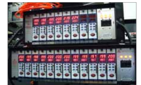
▲ 具智能化控制的熱澆道溫控箱
