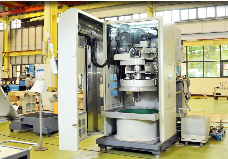
3D立體震動旋轉除毛邊機大幅提升除毛品質，也改善噪音問題。
