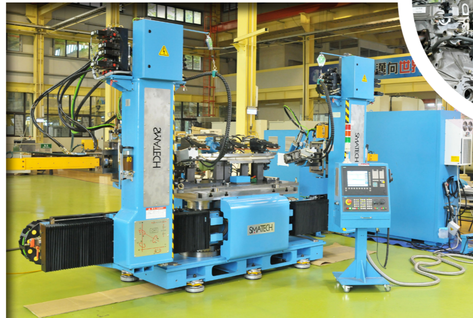
雙臂伺服彎曲機具備智慧調控功能，提高彎取的精準度。
