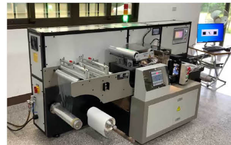
兆米智慧檢測所研發的 AOI 機台外觀。
