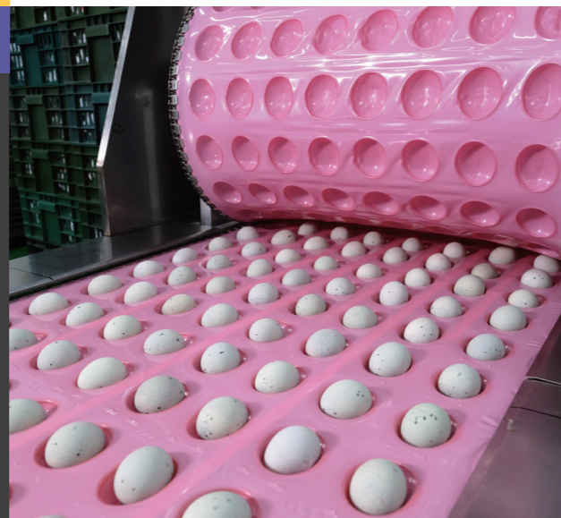
SBIR計畫支持的「上下雙面拉伸膜全自動真空包裝機」，大幅改善過去因為乳凸點所導致的漏氣問題。
