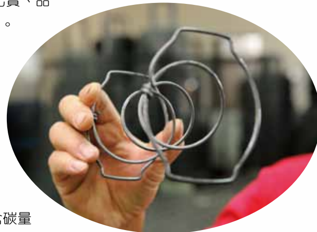
▲ 鋼的含碳量決定彈簧的好壞。從開業初，老K便堅持使用新鋼材做彈簧床。
