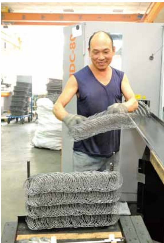
▲ 技術本位，老K的師傅們用手繙鋼線，打造好睡的彈簧床。
