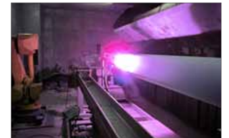
▲ 電漿噴塗熔射現場
