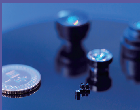
春虹光電的高畫素極微型雙目式立體影像內視鏡頭，是全球百萬畫素等級鏡片中，直徑尺寸最小的，僅有 1.4mm。
