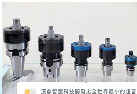
● 漢鼎智慧科技開發出全世界最小的超音波刀把——HSK-E25（右），透過無線電能傳輸，可達每秒 2 萬次的振動頻率，降低加工阻力。
