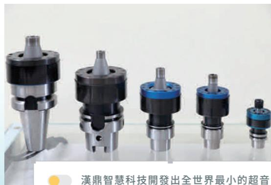
● 漢鼎智慧科技開發出全世界最小的超音波刀把——HSK-E25（右），透過無線電能傳輸，可達成每秒 2 萬次的振動頻率，降低加工阻力。
