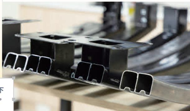
上泰工業的日型截面鈹件技術，以上下同步輥壓成形技術，只彎折 15 道次，領先全球。
