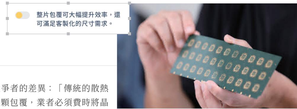
揚恩跟其他競爭者的差異：「傳統的散熱片大多採用單顆包覆，業者必須費時將晶片一小顆一小顆上膠黏在散熱片的機板上，再一顆一顆封裝；而揚恩則創新採用整片包覆，一次大面積黏貼、封裝，後續再裁切成小片。」
