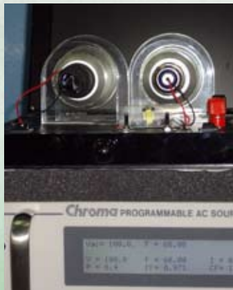
▲GM6108 驅動右側之LED燈泡。實測之輸入功率(P)為8.4W，功率因數(PF)為0.971
